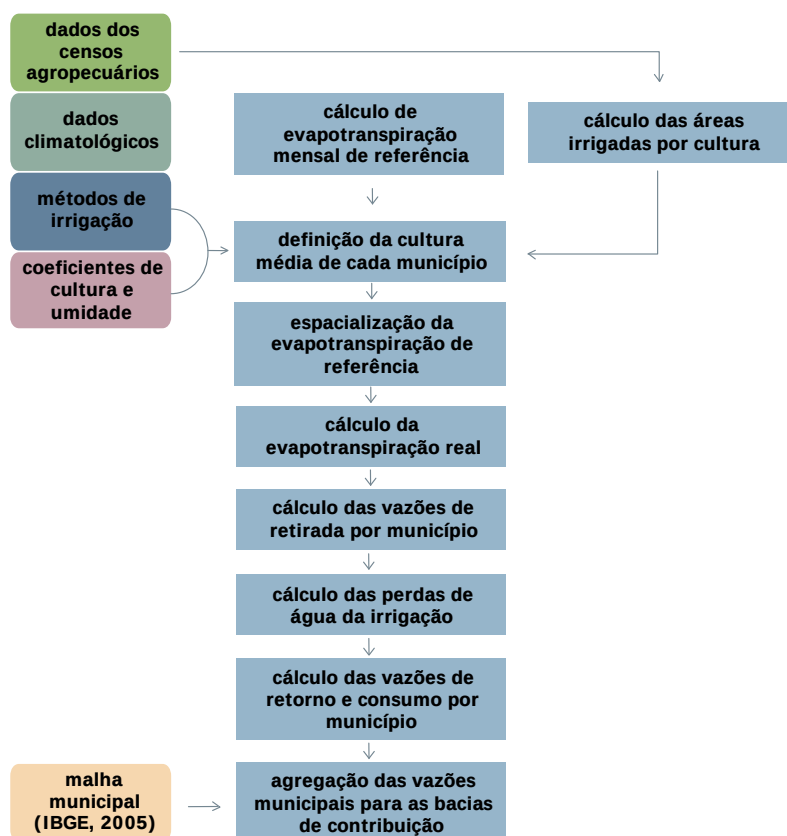
Figura 1. Fluxograma simplificado da metodologia utilizada na estimativa das vazões específicas para a irrigação.
